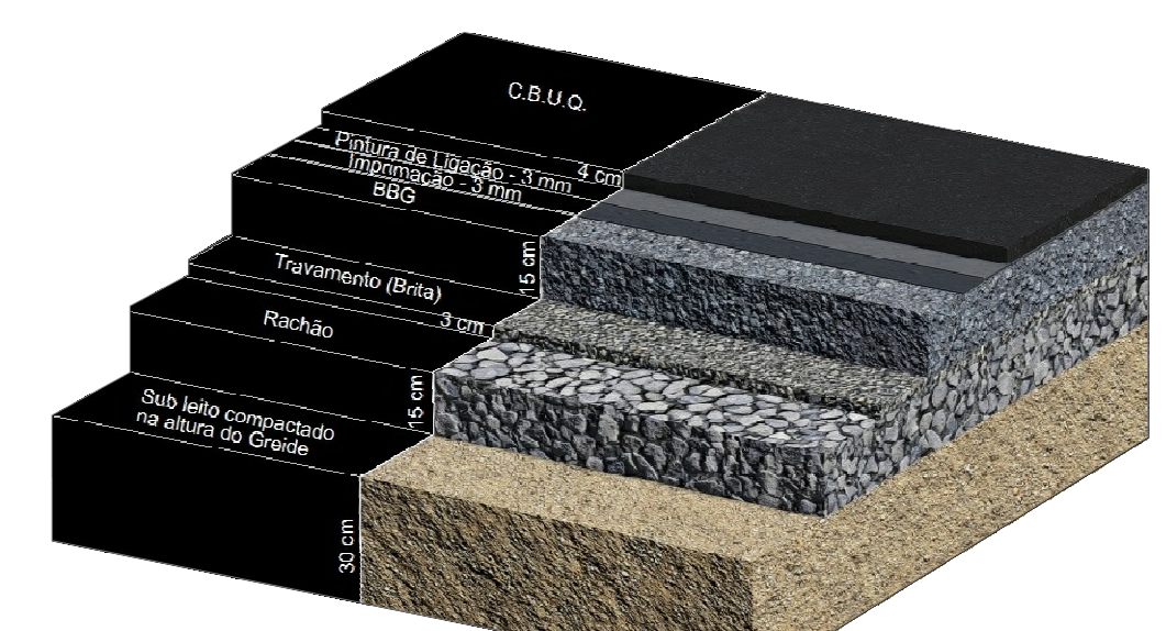
Detalhe das camadas da Pavimentação (C.B.U.Q.)
